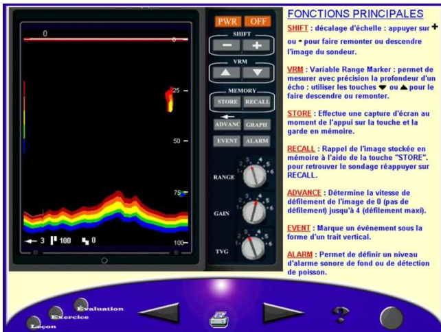
Un autre exemple où l'action de la souris sur les touches du sondeur déclenche les actions identiques à celle d'un sondeur réel (simulation).
